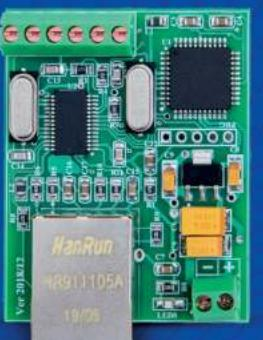
این مبدل امکان اتصال سنسورها را از طریق شبکه به دزدگیر فراهم می کند بدین معنی که از هر مکانی (چند متر تا کیلومترها) می توان سنسور را به دزدگیر متصل نمود تا در هنگام هشدار، دزدگیر شروع به اعلام خطر کند. سنسورها به برد NC4 متصل می شوند و این بر از طریق RS485 به دزدگیر وصل می شود.
