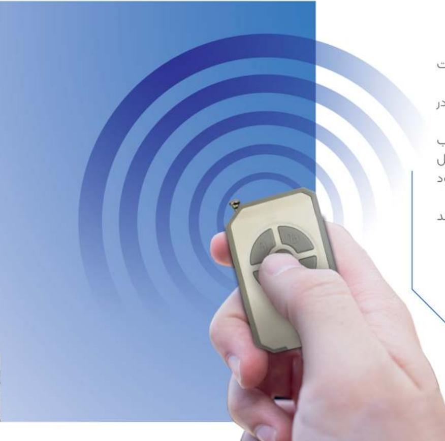
ولین و رایج ترین راه برای کنترل دزدگیر ریموت است. ریموت ها شامل فرکانس ۳۱۵ و ۴۳۳ مگاهرتز و در دو مدل کد لرن و کد هاپینگ تولید می شوند. برد مسافت ریموت بستگی به محیط نصب دزدگیر دارد که هر چه فضای بازتر و تداخل امواجی کمتر باشد، برد ریموت بیشتر می شود (در فضای باز تا ۲۵۰ متر جواب می دهد) فرکانس ریموت با فرکانس گیرنده دزدگیر باید یکی باشد.
